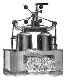
FIG. 83-THE LOW-LIFT VACUUM PUMP.
