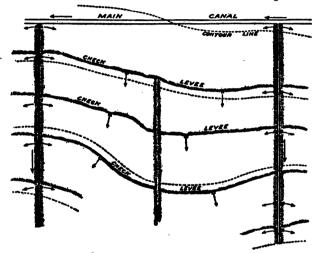
FIG. 56-CONTOUR OR BORDER SYSTEM.
