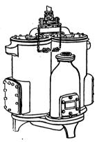
FIG. 84—HIGH-LIFT VACUUM PUMP.
